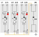
V : Varistance haute énergie GSG : Eclateur spécifique Ft : Fusible thermique C : Contact de télésignalisation t° : Système de déconnexion thermique MI : Indicateur de déconnexion
