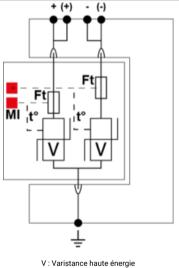
V : Varistance haute énergie Ft : Fusible thermique t° : Système de déconnexion thermique MI : Indicateur de déconnexion
