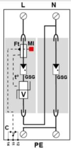
V : Varistor de alta energía GSG : Descargador specífico Ft : Fusible térmico C : Contacto de téléseñalización t° : Sistema de desconexión térmica MI : Indicador de desconexión
