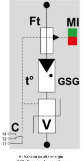
V : Varistor de alta energía GSG : Descargador specífico Ft : Fusible térmico C : Contacto de téléseñalización t° : Sistema de desconexión térmica MI : Indicador de desconexión
