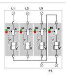
V : Varistance haute énergie Ft : Fusible thermique t° : Système de déconnexion thermique MI : Indicateur de déconnexion
