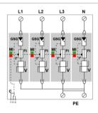
V : Varistor de alta energía GSG : Descargador specífico Ft : Fusible térmico C : Contacto de téléseñalización t° : Sistema de desconexión térmica MI : Indicador de desconexión
