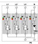
V : Varistor de alta energía Ft : Fusible térmico t° : Sistema de desconexión térmica MI : Indicador de desconexión
