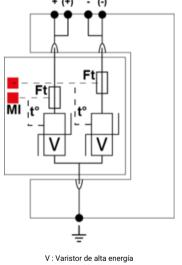
V : Varistor de alta energía Ft : Fusible térmico t° : Sistema de desconexión térmica MI : Indicador de desconexión
