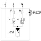
V : Varistor GSG : Descargador specifico Ft : Fusible térmico Buzzer : Indicador de desconexión audible t° : Sistema de desconexión térmica
