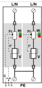
V : Varistance haute énergie Ft : Fusible thermique t° : Système de déconnexion thermique MI : Indicateur de déconnexion
