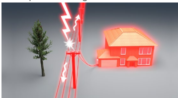
3. Impact sur ligne aérienne
