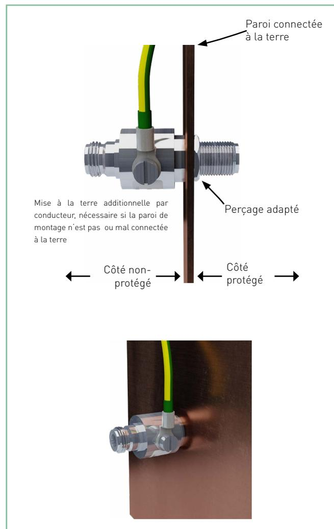
Remarque : Le concept de côté protégé/non protégé est une recommandation pour conserver le principe de «boîtier» mais le parafoudre est bidirectionnel
