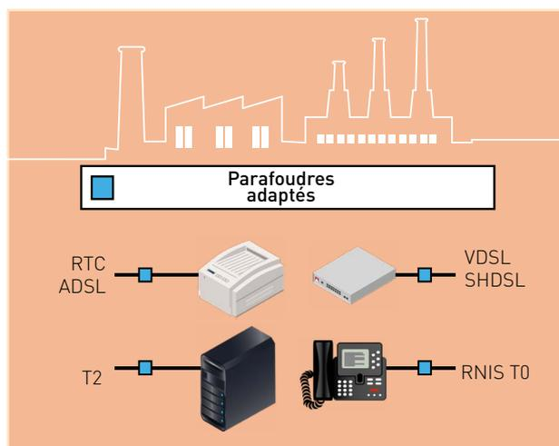
A chaque type de ligne télécom, un schéma de protection adaptée devra être utilisé :
