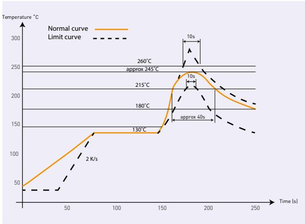
**Cycle soudure à la vague pour éclateurs à gaz**
