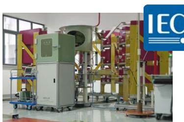
Les équipements et bancs d'essais sont étudiés pour être modulables et les équipes d'experts CITEL sont aussi capables de réaliser des tests sur mesure (Hors norme).
