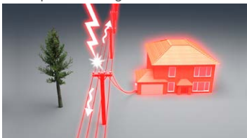
3. Impact sur ligne aérienne
