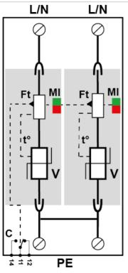
V : Varistor de alta energía Ft : Fusible térmico C : Contacto de teleseñalización t° : Sistema de desconexión térmica MI : Indicador de desconexión
