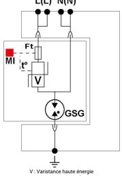
GSG: Eclateur spécifique Ft: Fusible thermique t°: Système de déconnexion thermique MI: Indicateur de déconnexion
