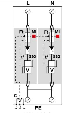
V : Varistance haute énergie GSG : Eclateur spécifique Ft : Fusible thermique C : Contact de télésignalisation t° : Système de déconnexion thermique MI : Indicateur de déconnexion
