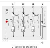
V : Varistor de alta energia GSG : Descargador specífico Ft : Fusible térmico C : Contacto de téléseñalización t° : Sistema de desconexión térmica MI : Indicador de desconexión
