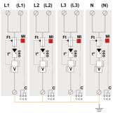
V : Varistance haute énergie GSG : Eclateur spécifique Ft : Fusible thermique C : Contact de télésignalisation t° : Système de déconnexion thermique MI : Indicateur de déconnexion
