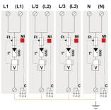
V : Varistance haute énergie GSG : Eclateur spécifique Ft : Fusible thermique C : Contact de télésignalisation t° : Système de déconnexion thermique Ml : Indicateur de déconnexion
