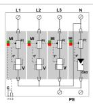
V : Varistance haute énergie GSG : Eclateur spécifique Ft : Fusible thermique C : Contact de télésignalisation t° : Système de déconnexion thermique MI : Indicateur de déconnexion
