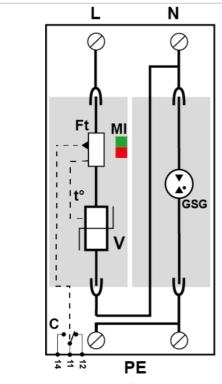
V : Varistance haute énergie GSG : Eclateur spécifique Ft : Fusible thermique t\* : Système de déconnexion thermique MI : Indicateur de déconnexion
