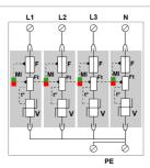
V : Varistor de alta energía Ft : Fusible térmico F : Protección contra la sobretensión (fusible) t° : Sistema de desconexión térmica MI : Indicador de desconexión
