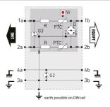
G: Descargador tripolar Gb: Descargador bipolar PTC: Resistor térmico R: Resistor D: Diodo limitador Vi: Indicador
