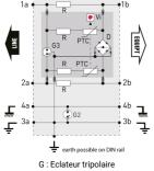
G: Eclateur tripolaire Gb: Eclateur bipolaire PTC: Résistance thermique R: Résistance D: Réseau de diode d'écrêtage Vi: Indicateur
