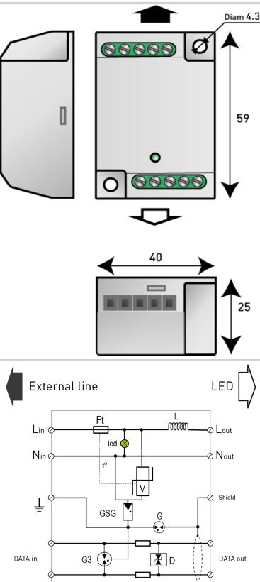
GSG : Descargador específico G : Descargador de gas 2-polos
