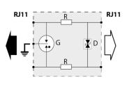
P : Eclateur à gaz tripolaire R : Résistance D : Diode d'écrêtage
