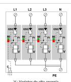
V: Varistor de alta energía GSG: Descargador specífico F1: Fusible térmico C: Contacto de téléseñalización t\*: Sistema de desconexión térmica MI: Indicador de desconexión
