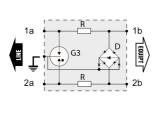
G : Descargador tripolar R : Resistancia D3 : Diodo limitador tripolar
