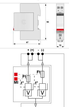
V : Varistor de alta energía Ft : Fusible térmico t° : Sistema de desconexión térmica MI : Indicador de desconexión
