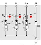
V : Varistor de alta energía GSG : Descargador specífico F1 : Fusible térmico t° : Sistema de desconexión térmica MI : Indicador de desconexión
