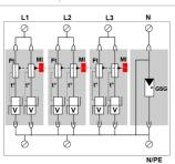
V : Varistor de alta energía Ft : Fusible térmico t° : Sistema de desconexión térmica MI : Indicador de desconexión
