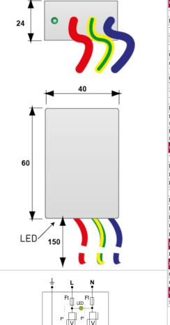
V : Varistance GSG : Eclateur spécifique LED : Indicateur de déconnexion Ft : Fusible thermique t° : Système de déconnexion thermique
