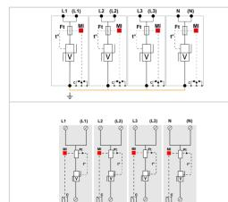
V : Varistor de alta energía Ft : Fusible térmico C : Contacto de teleseñalización t° : Sistema de desconexión térmica MI : Indicador de desconexión
