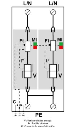
t° : Sistema de desconexión térmica MI : Indicador de desconexión
