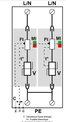
V : Varistance haute énergie Ft : Fusible thermique C : Contact de télésignalisation t° : Système de déconnexion thermique MI : Indicateur de déconnexion
