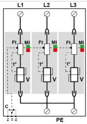
V : Varistance haute énergie Ft : Fusible thermique C : Contact de télésignalisation t° : Système de déconnexion thermique MI : Indicateur de déconnexion
