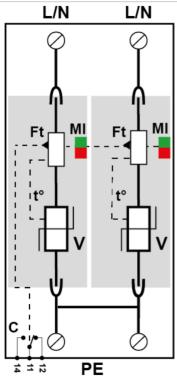
V : Varistor de alta energía Ft : Fusible térmico t° : Sistema de desconexión térmica MI : Indicador de desconexión
